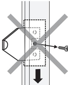
中央の取付けビスは外さないでください。サッシ内部の締付け用パーツが落下し交換できなくなる恐れがあります。
