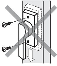
サッシ内部の締め付け用のパーツが落下し、交換ができなくなる恐れがあります。
