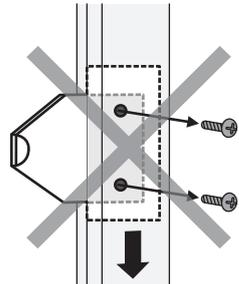
サッシ内部に締付け用パーツを使用している場合があります。上下のビスを外すとパーツが落下し交換できなくなります。お電話にてご相談ください。
