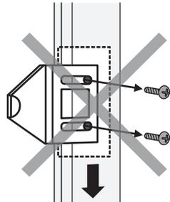
2本の取付けビスを同時に外さないでください。サッシ内部の締付け用パーツが落下し交換できなくなる恐れがあります。
